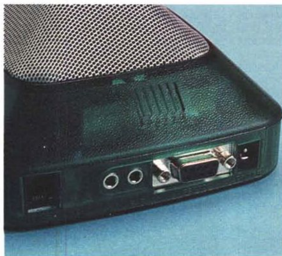
Sul retro sono presenti la connessione RS 232 seriale, la presa di alimentazione, quella telefonica, e la coppia di ingressi/uscite audio per l'utilizzo delle funzioni voice.
